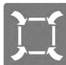
Notre modèle est doté d'un système d'aspiration périmétrique performant. L'aspiration se fait par les fenêtres situées sur les pourtours de la hotte, les vapeurs et les fumées issues de la cuisson sont capturées grâce à un rideau dépressionnaire. Ce système offre un design plus discret et reste facile d'entretien.
