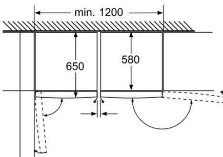
Parements entièrement amovibles lorsque l'appareil est directement placé sur un mur.
