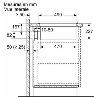
En cas d'installation directement contre des murs extérieurs qui ne sont pas isolés ( $\mu \geq 0,5 \text{ W/m}^2 \cdot \text{°C}$ ), nous recommandons d'utiliser des configurations de recyclage partiellement ou totalement gainées.
