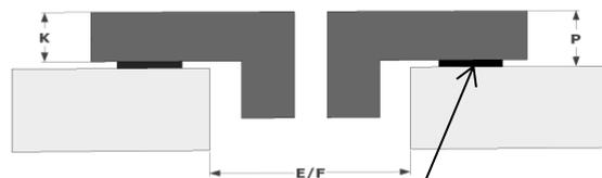
Joint d'étanchéité 2mm
