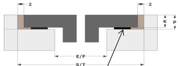
Joint d'étanchéité 2mm
