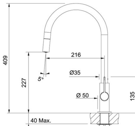
Diamètre de perçage  $\varnothing$  35 mm
